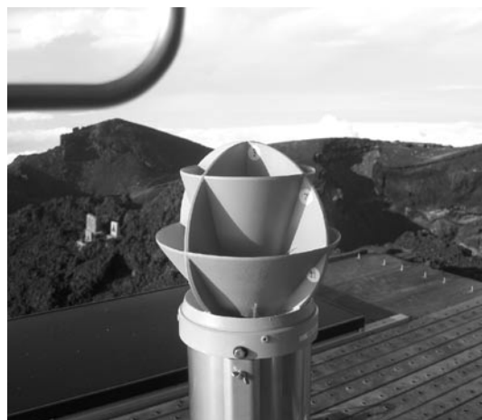
図6 3次元雨量計（富士山測候所での観測）
